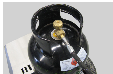
Fig. 3-8: Gas slang aansluiten
